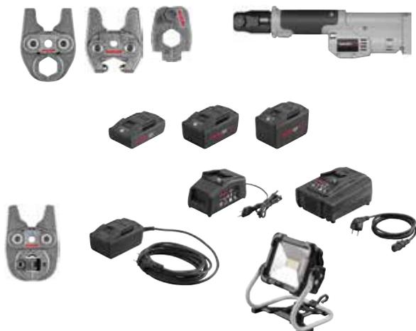
**Superhandliche, superleichte, robuste Hybrid-Radialpresse 22 kN, für Akku- und Netzbetrieb, mit automatischem Rücklauf (Zwangsablauf). Für Radial-Pressverbindungen Ø 10–40 mm, Ø ¼–1 ¼". Li-Ion 22 V Technology! Akku Li-Ion 21,6 V, 2,5 Ah, für ca. 390 Pressungen mit einer Akkuladung\*.**
