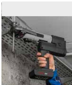
**Universelle, superhandliche, robuste Hybrid-Radialpresse 32 kN, für Akku- und Netzbetrieb, mit automatischem Rücklauf (Zwangsablauf) und Pressdruck-Monitoring. Anti-Vibrations-System. Für Radial-Pressverbindungen Ø 10–108 (110) mm, Ø ¼–4". Li-Ion 22 V Technology! Akku Li-Ion 21,6 V, 2,5 Ah, für ca. 200 Pressungen mit einer Akkuladung.**
