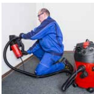
**Leistungsstarkes, kompaktes, handliches Diamant-Schlitz- und Trennschleifgerät zum trockenen Schlitzten und Trennen mineralischer Werkstoffe, z. B. Beton, Stahlbeton, Mauerwerk aller Art, Natursteine, Estrich aller Art. Für eine Schlitztiefe bis 61 mm und eine Schlitzbreite bis 62 mm.**
