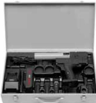
**Superhandliche, superleichte, robuste Hybrid-Axialpresse 20 kN bzw. 13 kN, für Akku- und Netzbetrieb, mit automatischem Rücklauf (ACC). Für Druckhülsenverbindungen Ø 12–40 mm. Li-Ion 22 V Technology! Akku Li-Ion 21,6 V, 2,5 Ah, für ca. 500 Pressungen mit einer Akkuladung\*.**
