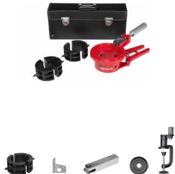
**Robustes Rohrtrenn- und Rohrfanfasgerät aus Metall zum rechtwinkligen, planen Trennen und Anfasen (15°) von Kunststoffrohren aus ABS, PB, PE, PE-HD, PE-X, PVC, PVDF, Ø 40–110 mm.**
