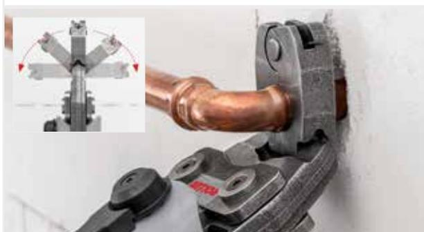
**Beispiel: ROLLER'S Presszange Mini V:** Abdruck "V" auf gepresstem Fitting zur Rückverfolgbarkeit gemäß EN 1775:2007.
