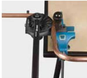
**Robuster Hand-Rohrbieger für harte, halbharte und weiche Kupferrohre (auch dünnwandig), Ø 10–22 mm, Ø 3/8–7/8", weiche ummantelte Kupferrohre (auch dünnwandig) Ø 10–18 mm, nicht-rostende Stahlrohre der Pressfitting-Systeme Ø 12–18 mm, C-Stahlrohre der Pressfitting-Systeme Ø 12–22 mm (ummantelt bis Ø 18 mm), weiche Präzisionsstahlrohre Ø 10–20 mm, Elektroinstallationsrohre EN 50086 Ø 16–20 mm, Verbundrohre Ø 14–32 mm.**
