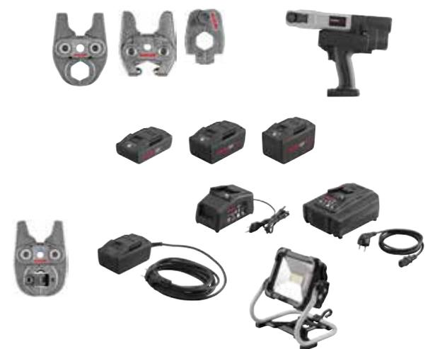
**Superhandliche, superleichte, robuste Hybrid-Radialpresse 22 kN, für Akku- und Netzbetrieb, mit automatischem Rücklauf (Zwangsablauf). Für Radial-Pressverbindungen Ø 10–40 mm, Ø ¼–1 ¼". Li-Ion 22 V Technology! Akku Li-Ion 21,6 V, 2,5 Ah, für ca. 390 Pressungen mit einer Akkuladung\*.**
