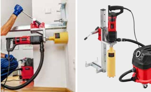
**Leistungsstarke, robuste, handliche Diamant-Kernbohrmaschine mit Mikro-Impuls-Technik. Zum Kernbohren ohne Wasser, z. B. in Beton, Stahlbeton bis Ø 162 (202) mm, in Mauerwerk aller Art, Natursteine, Asphalt, Estrich aller Art, bis Ø 202 mm. Speziell zum Trockenbohren, handgeführt oder mit Bohrständer.**
