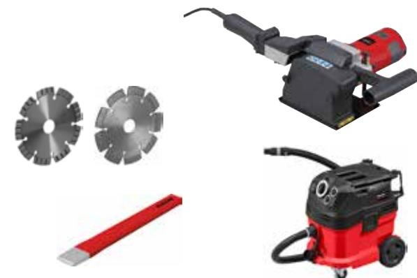
**Leistungsstarkes, kompaktes, handliches Diamant-Schlitz- und Trennschleifgerät zum trockenen Schlitzten und Trennen mineralischer Werkstoffe, z. B. Beton, Stahlbeton, Mauerwerk aller Art, Natursteine, Estrich aller Art. Für eine Schlitztiefe bis 38 mm und eine Schlitzbreite bis 43 mm.**
