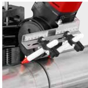
**Kompakte, leichte, robuste Hybrid-Rohrtrennmachine für Akku- und Netzbetrieb. Zum mobilen Trennen und Entgraten von Rohren der Pressfitting-Systeme aus nichtrostendem Stahl, Kupfer, C-Stahl, Ø 8–108 mm, Stahlrohren EN 10255 (DIN 2440) DN 6–100, Ø 1/8–4", Ø 10–115 mm, Gussrohren (SML) EN 877 (DIN 19522) DN 50–100, Kunststoffrohren SDR 11 Wanddicke s ≤ 10 mm, Ø 10–110 mm, Ø 1/8–4", Verbundrohren Ø 10–110 mm. Akku Li-Ion 21,6 V, 5,0 Ah, für ca. 280 Abschnitte Ø 22 mm mit einer Akkuladung\*.**
