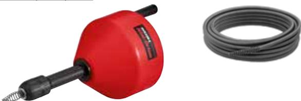
**Robustes, handliches Hand-Rohrreinigungsgerät für Hand- und Elektroantrieb, für Rohre Ø 20–50 (75) mm, für Rohrreinigungsspiralen Ø 6, 8, 10 mm.**
