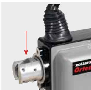
Außerhalb des Gehäuses liegende Spannbacken!
