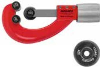
**Kompakter, robuster Qualitäts-Rohrabschneider mit nadelgelagertem Schneidrad und nadelgelagerten Gegendruckrollen, speziell für gewellte Metallschläuche (Wellrohre) aus nichtrostendem Stahl, auch ummantelt, DN 10-32 (40), Ø 3/8-1 1/2" (2").**
